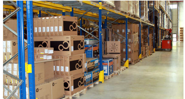
Au sol, le picking, et en hauteur : la réserve LM7 cherche à mettre les produits en réserve au plus près du picking.
